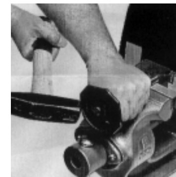
12. Positionner les agrafes non rivetées dans les trous par la gauche et continuer le processus décrit ci-dessus.
