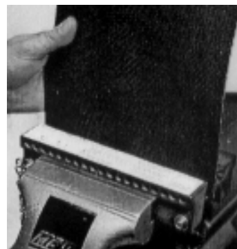
6. Raccorder la bande avec la marquage (largeur de bande ou no. d'agrafes).
