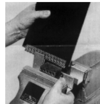
11. Ouvrir l'étau et à l'aide d'une légère pression, sortir la courroie vers l'arrière.
