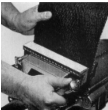
17. Reprendre les mêmes étapes sur l'autre extrémité de la courroie. Attention! Le même profil doit se trouver à l'arrière.
