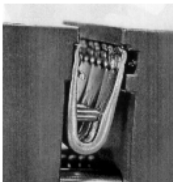
5. Fermer l'étau jusqu' à ce que les agrafes viennent en butée. Laisser suffisamment ouvert pour permettre le passage de la courroie.
