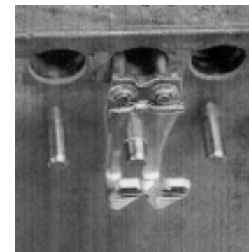
4. Deux rivets de la même agrafe doivent se trouver dans la même trou.
