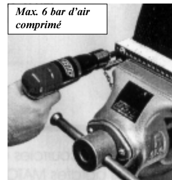
7. Bien maintenir la courroie sur la butée et fermer complètement l'étau.
