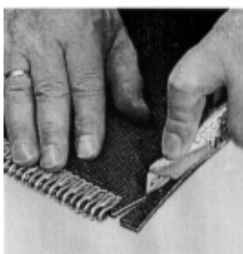
18. Bishauter une extrémité de la courroie sur 2 cm. À côté de l'agrafe, il doit rester 5 mm de courroie.
