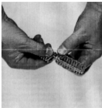
14. On peut enlever un certain nombre d'agrafes pour réaliser d'autres largeurs de courroies.
